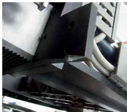
Verbogene Halterung am Druckkopfschlitten.
